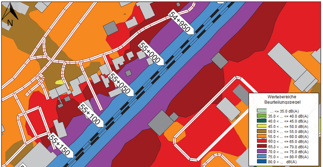
Abbildung 4: Berechnung Raster in 5,1 m Höhe für den Nachtzeitraum L_{night} (kann auch für den Tageszeitraum verwendet werden) für Bereich 2 [37].
