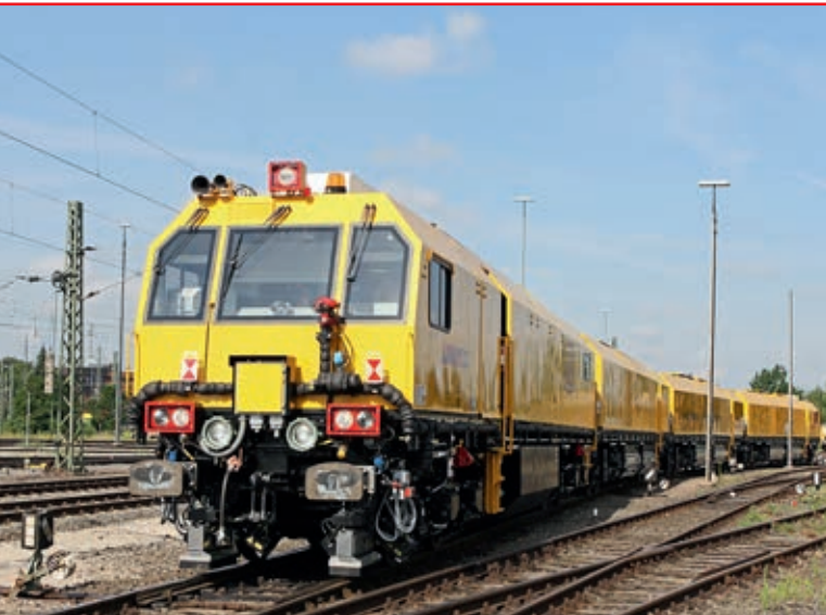
Der Hochleistungs-Schienenschleifzug „Eagle“ im Einsatz
